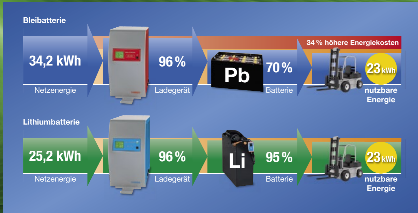
Vergleich der nutzbaren Energie bei Blei- und Lithiumbatterien
