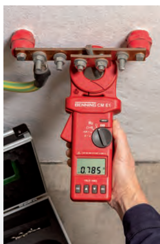
Messung des Erdschleifenwiderstandes eines Anlagenerders
