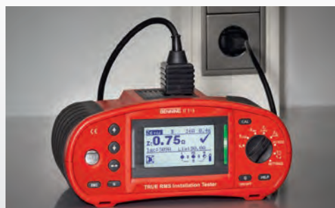
IT 115 bei der Schleifenimpedanzmessung ohne RCD-Auslösung
