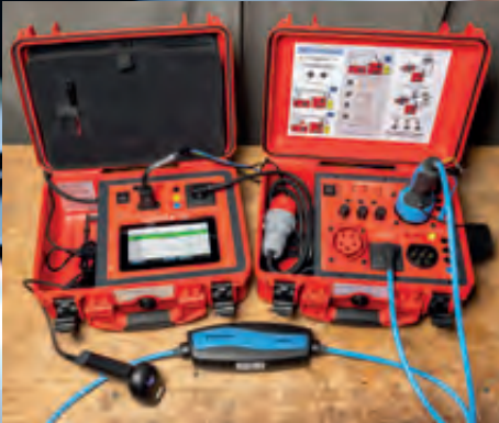
Prüfung einer 1-phasigen Ladeleitung Mode 2
