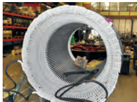
Neu gewickelter Elektromotor vor der Tränkung
