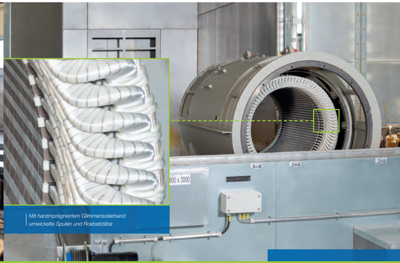
Ein fertiger Stator wird aus dem Trockenofen gefahren
